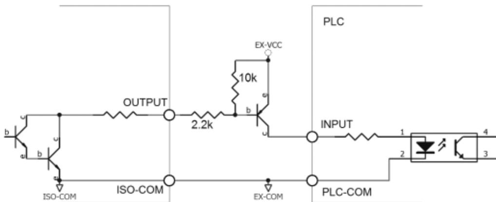
图 7-15 输出到 PLC 正公共端子
