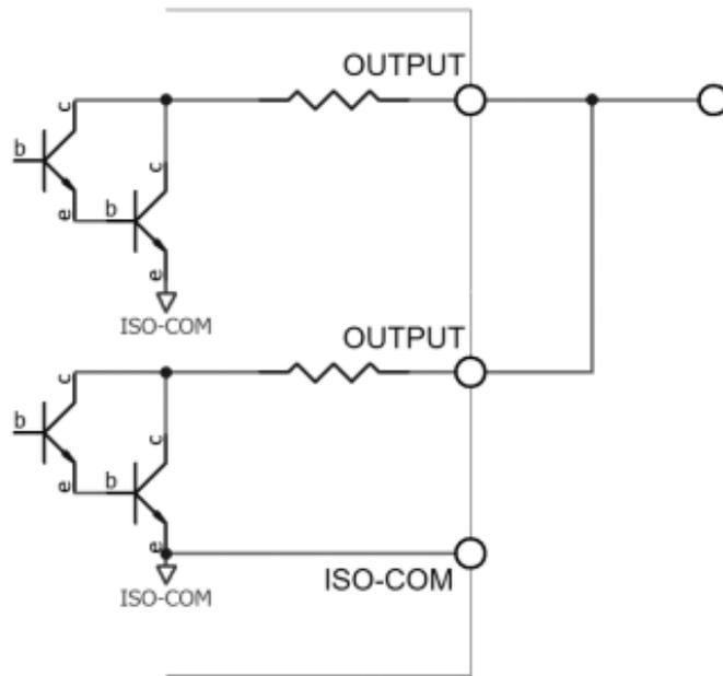
图 7-13 双端口输出组成逻辑或电路
