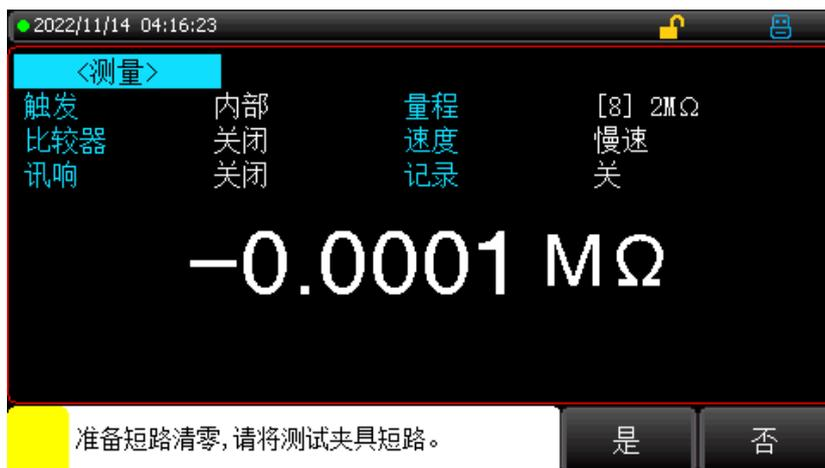
**第3步** 清零完成后，蜂鸣器响起，仪器屏幕中间显示“清零成功！”。若清零时底数过大则显示“清零失败！”。
